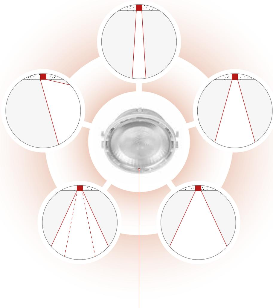
Asymmetrisch, breit oder eng strahlend. Allgemeinbeleuchtung oder punktgenaue Anstrahlung. Mit dem Optical Core System lassen sich verschiedenste Lichtverteilungen und Abstrahlcharakteristiken realisieren. Das äußere Erscheinungsbild der Leuchte und alle übrigen Bauteile bleiben immer gleich.
